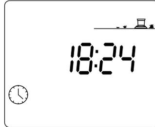
Beachte: Die 2 blinkenden Punkte zwischen Stunden und Minuten bedeuten, dass die aktuelle Uhrzeit angezeigt wird.
