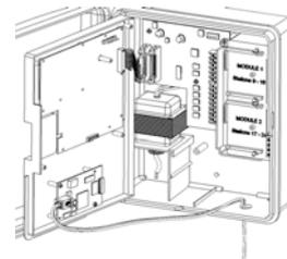
4 - Schließen Sie die Transformorkabel an die Träger-Leiterplatte (Mother Board) an, wie in Diagramm 4 gezeigt.
