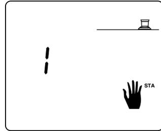
Die Beregnungsdauer erscheint nach einer Sekunde auf der Anzeige und wird in 1-Min. Schritten abgezählt.
