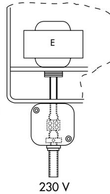
**Beachte:** Das Steuergerät erkennt den Anschluss eines Erweiterungsgerätes, sobald die 230 V Stromversorgung wieder angeschlossen ist.
