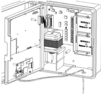
5 - Verbinden Sie die Telefonleitung mit dem Modem, wie in Diagramm 5 gezeigt.
